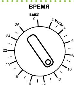
Для того чтобы установить время работы дегидратора с механическим таймером, поверните регулятор таймера до нужного деления. В процессе сушки регулятор будет показывать оставшееся время. На страницах 9-12 представлен список продуктов и примерное время, необходимое для их эффективной сушки. Однако время сушки очень сильно зависит от множества факторов:
