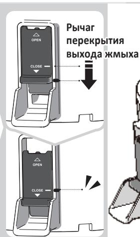
Рычаг перекрытия выхода жмыха
