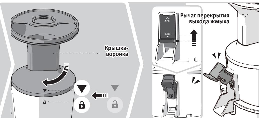
**04** Поверните крышку-воронку по часовой стрелке до отметки [ ]. Если внутренние детали были собраны неправильно, крышка-воронка не закроется.
