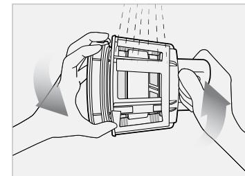
**3** Хорошо промойте внешние и внутренние поверхности фильтр-сетки под проточной водой.
