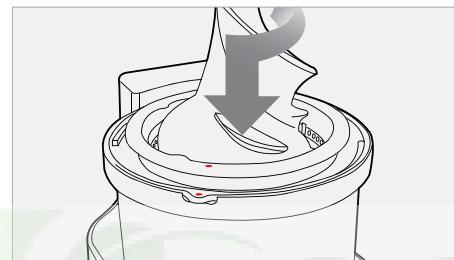
Прим. Для закрытия крышки, шнек должен быть установлен на место.
