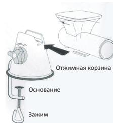
\*Обратите внимание, что передняя крышка закручивается в направлении против часовой стрелки. А колпачок – по часовой стрелке.
