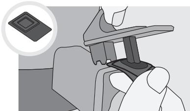
Откройте клапан, придержите его с одной стороны и снимите силиконовый уплотнитель с другой стороны, чтобы разобрать.
