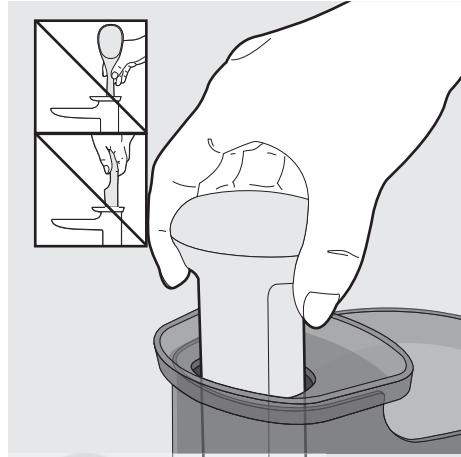
**8. Для загрузки продуктов в отжимную корзину, используйте только оригиналный толкатель.**
