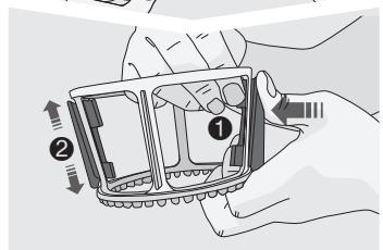
**3 ①** Через центр слота вставьте верхнюю часть лопатки и потяните вверх. Через центр слота вставьте нижнюю часть лопатки и потяните ее вниз. Нажмайте на щетку с внешней стороны по всей поверхности лопатки.
