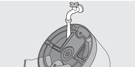
Во время очистки отжимной корзины, вымывайте остатки продуктов внутри и снизу отжимной корзины под проточной водой.
