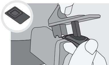
Откройте клапан, придержите его с одной стороны и снимите силиконовый уплотнитель с другой стороны, чтобы разобрать.
