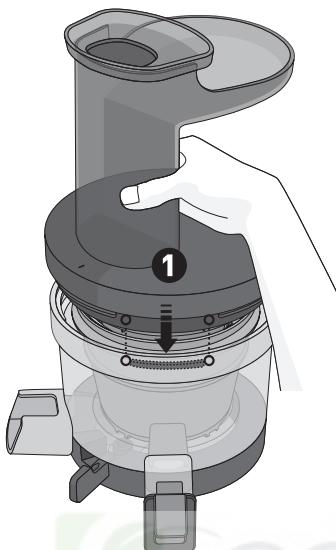
Установите крышку-воронку отжимной корзины, как показано на рисунке, поверните по часовой стрелке до упора.
