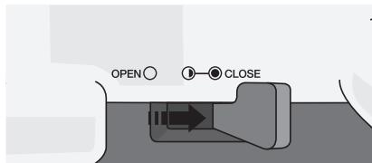
**1 Поместите рычаг перекрытия выхода жмыха в положение «Закрыто» [● CLOSE], перед тем, как начать работу.**
