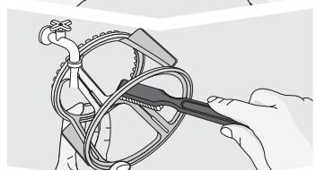
**2** При помощи чистящей щетки промойте внутри и снаружи корпус обтирателя под проточной водой. Таким же образом промойте силиконовую лопатку обтирателя. Используйте щетку, чтобы вычистить частицы продуктов в пазах силиконовых лопаток.
