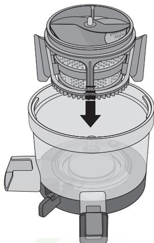
Установите собранные детали из пункта 2 в отжимную корзину, поверните сито из стороны в сторону, чтобы закрепить детали в пазах.
