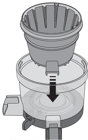
Вставьте насадку-измельчитель в отжимную корзину, как показано на рисунке. Выровняйте отверстие насадки-измельчителя с носиком для выхода сока на отжимной корзине.
