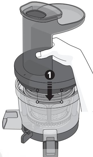
Установите крышку на отжимную корзину, как показано на рисунке, поверните по часовой стрелке до упора.
