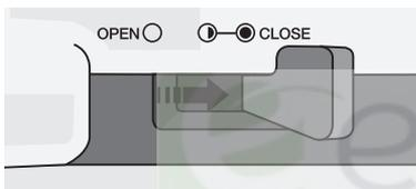
При использовании насадки-измельчителя поставьте рычаг в положение [●CLOSE] и оставьте в этом положении до конца работы, чтобы не допустить выхода смеси через отверстие для жмыха.
