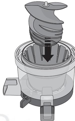
Вставьте шнек в насадку-измельчитель. Поворачивайте его из стороны в сторону до тех пор, пока он не встанет на место.
