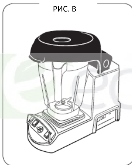
Фиксирующая крышка в закрытом положении. К блендеру подается питание.
