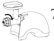
Когда детали будут собраны, подсоедините фиксирующее кольцо и поверните его по часовой стрелке до упора.
