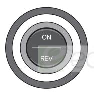
Если шнеки перестали вращаться, нажмите и удерживайте кнопку «REV», в течение 3-5 секунд, затем отпустите. Повторите процедуру 2-3 раза. Кнопка «REV» помогает протолкнуть ингредиенты, предотвращая затор.
