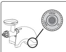
Для удобства, классический предохранитель заменен многоразовым и выполнен в виде кнопки «Reset», которая расположена в нижней части устройства. В случае короткого замыкания или перегрузки аппарата, нажмите эту кнопку для продолжения работы.
