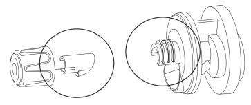
З сборка крышки отжимной корзины и регулятора выхода жмыха.
