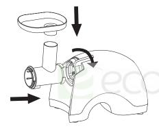
Подсоедините отжимную корзину с установленной на нее воронкой к корпусу. Поверните фиксирующее кольцо в положение «CLOSE» («ЗАКРЫТО»).
