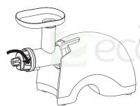
Когда аппарат будет полностью собран, вставьте регулятор выхода жмыха в крышку и поверните его по часовой стрелке.
